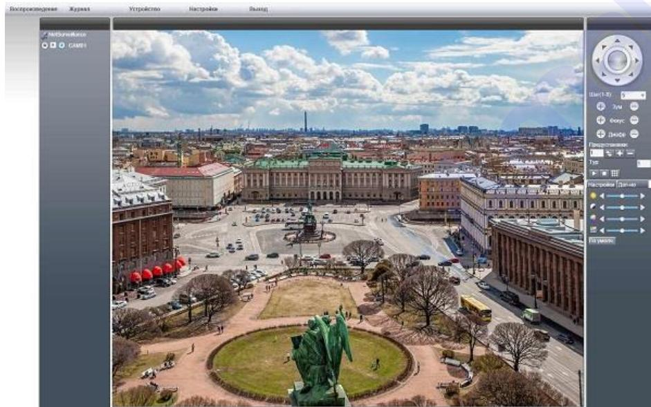
Веб-интерфейс IP камеры позволяет вести видеонаблюдение в реальном времени, управлять поворотной камерой (для некоторых моделей), изменять настройки камеры, вести локальную видеозапись, воспроизводить архив, изменять параметры изображения и др.
